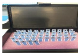
Schema de principiu a sistemului electrochimic portabil pe baza de electrozi serigrafiați de carbon pentru analiza ionilor de Hg(II)
